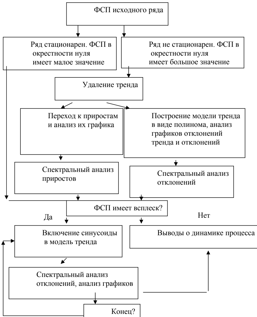
Рис. 13 Схема итеративного процесса построения циклической модели временного ряда на основе оценок спектрального и регрессионного анализов
